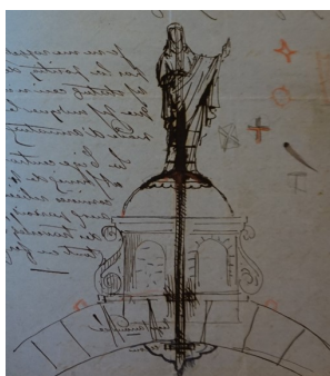
Dessin de l'orfèvre Chertier proposant le mode de fixation de la statue. ADV 1/250 fonds Garcin
